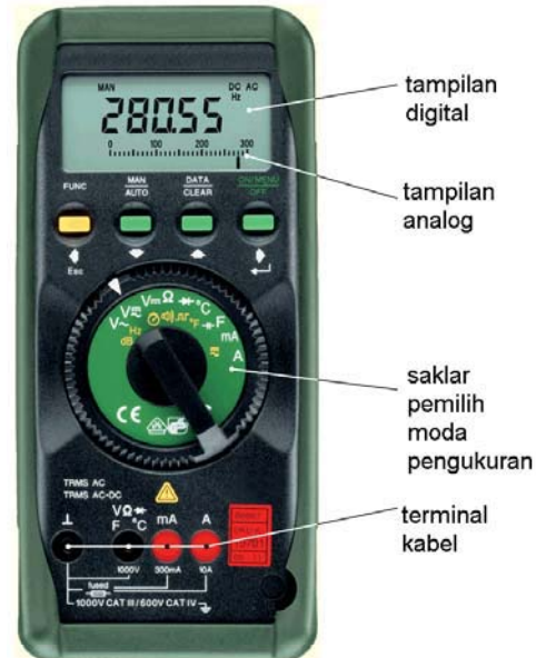
Gambar 8.1 : Tampilan meter Digital
